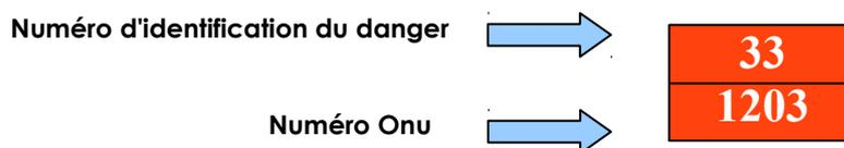
Parallèlement à cette signalisation orange, les véhicules-citernes, les wagons-citernes, les véhicules ou wagons destinés au transport en vrac, ainsi que les colis contenant des marchandises dangereuses doivent porter des plaques-étiquettes indiquant les risques présentés par la matière (les modèles d'étiquettes sont présentés plus loin).
